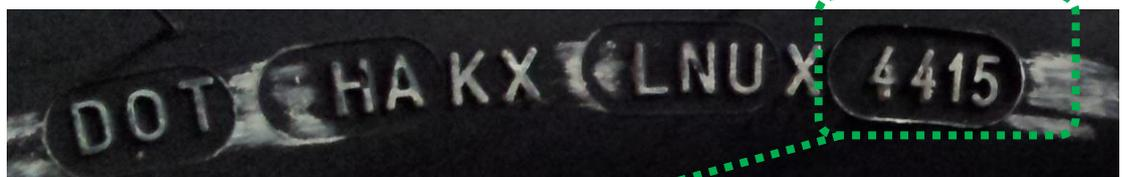
Das Reifenherstellungsdatum ist als eine vierstellige Zahl, auf der Reifenseitenwand angebracht. Die ersten zwei Ziffern stehen für die Kalenderwoche und die zwei letzten Ziffern das Jahr der Herstellung des Reifens. Dieser Reifen wurde in KW 44 2015 gefertigt.
